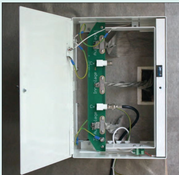
Abb. 4: Blick in das geöffnete Anschlusselement für die drei Lagen Vlies (Foto: Schmeissner)
